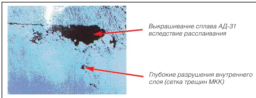
Рис. 1. Микрофотография межкристаллитной коррозии алюминиевого сплава АД-31
